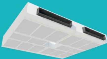
Ламинарный потолок - это устройство подачи стерильного однонаправленного потока воздуха, обеспечивающего защиту рабочей зоны (все асептическое пространство хирургического воздействия, включая столы для инструмента и материалов, а также свободную зону для стерильно одетого оперирующего персонала и передачи стерильных материалов) от патогенных микроорганизмов, способных вызвать заражение пациента, а также механических частиц и вредных веществ, способных нанести вред его здоровью.
