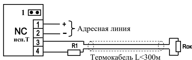
Рис.6. Схема подключения к ELEKOR-NC исп.Т линейного извещателя (термокабель). При установленном джампере 1 при срабатывании извещателя адресная метка формирует сигнал «Внимание», при снятом джампере – сигнал «Пожар». Номиналы резисторов (0,25 Вт, \pm 5\% ): R_{ок} = 2,2 \text{ кОм} ; R_1 = 560 \text{ Ом} .
