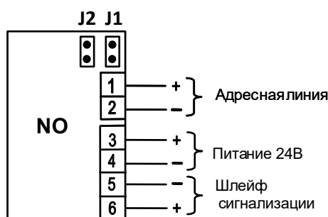
Рис. 2. Назначение клемм адресных меток ELEKOR-NO.
