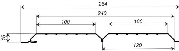
**Сайдинг Лбрус-15x240** — это профилированные панели из оцинкованной стали, обработанные декоративно-защитным покрытием Полиэстер. Его часто приобретают в Ташкенте — с помощью него монтируют фасад. Металлический сайдинг по многим параметрам практичнее натуральных материалов, поскольку противостоит внешним воздействиям; фасад, облицованный сайдингом, выглядит респектабельно. Металлосайдинг — современный и доступный материал для вашего фасада!
