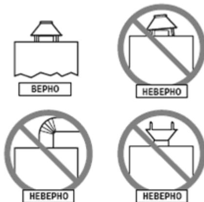
Рис. 10. Установка тягопрерывателя
