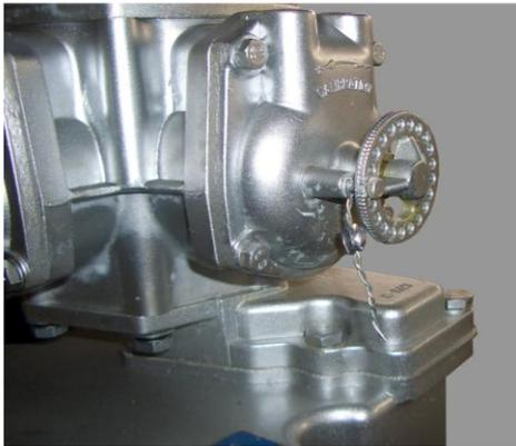
Схема пломбировки измерителя объема
