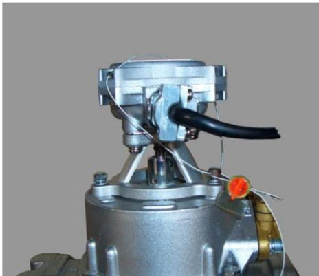
Схема пломбировки датчика импульсов
