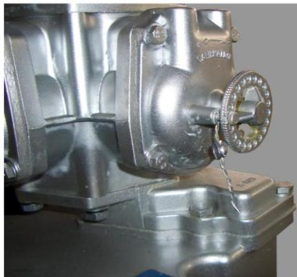
Схема пломбировки измерителя объема
