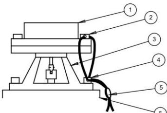
Рис.2. Схема пломбировки датчика импульсов
