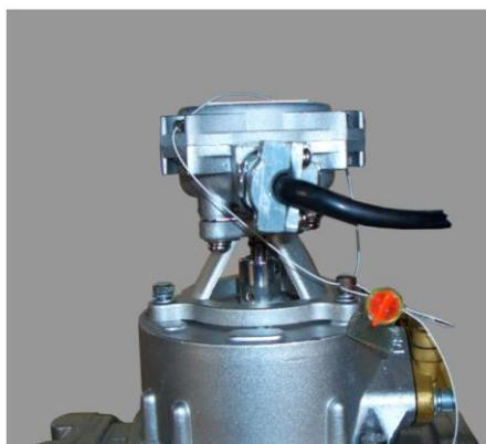
Схема пломбировки датчика импульсов
